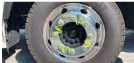
ISO規格のホイール車には全車に取り付け、目視により緩み確認を行っている。
